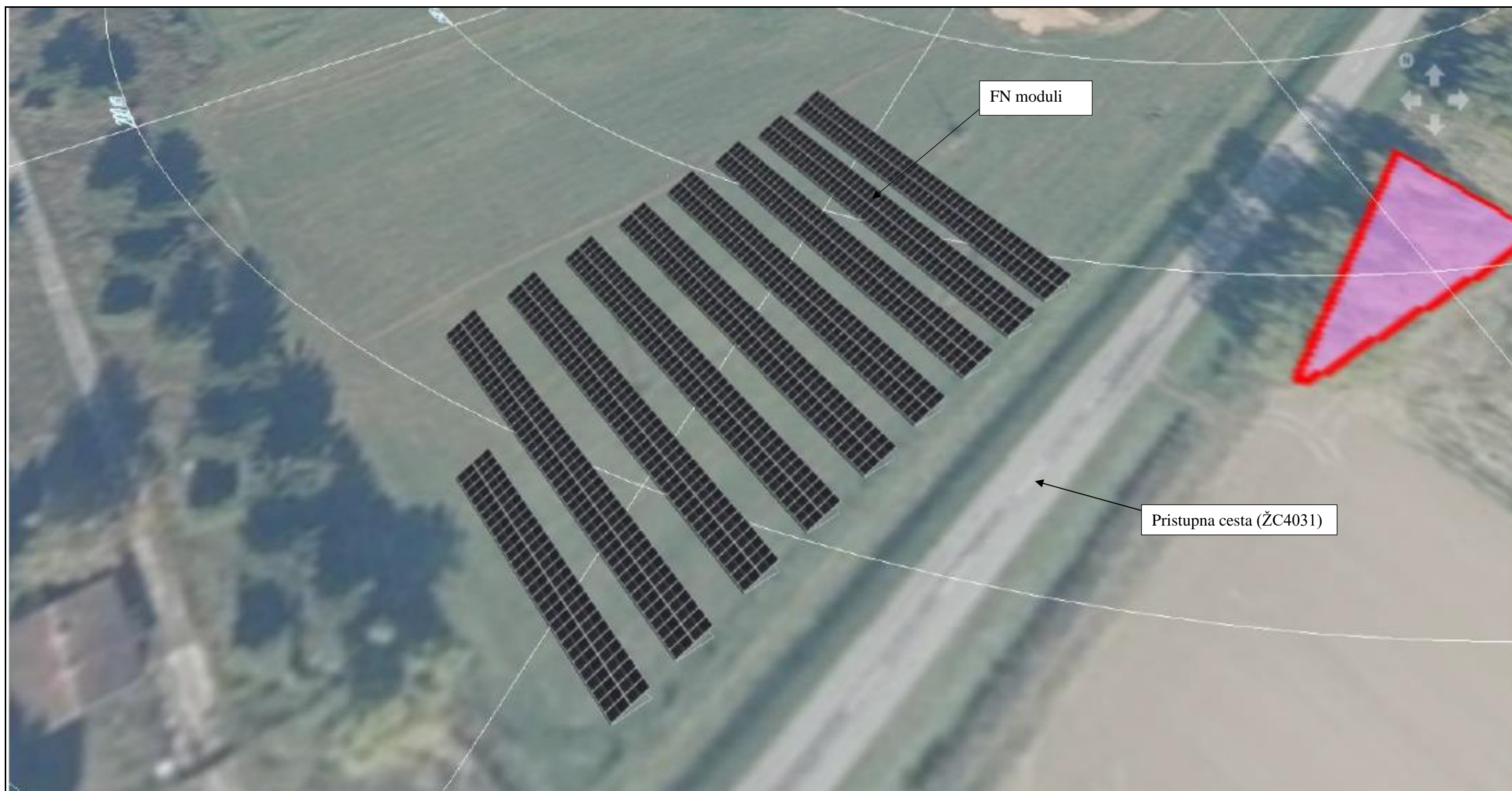
Slika 4. SE - Situacija i dispozicija FN modula (Izvor: DEGAL TEHNIKA d.o.o., Virovitica, studeni 2022.)
